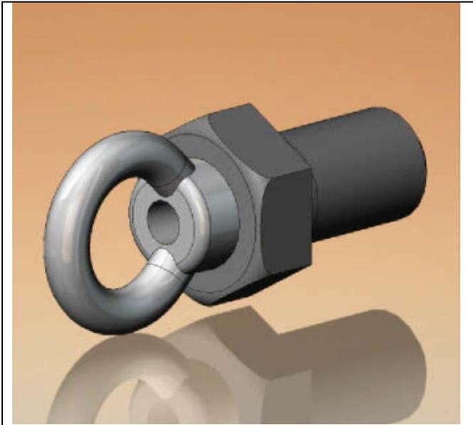
Рис. 11. Крюк для строповки
