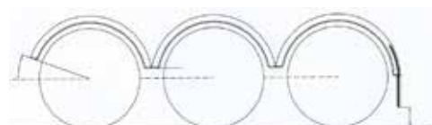
EXEMPLE 2. Roues non directrices, distance entre les pneumatiques inférieure à 250 mm.
