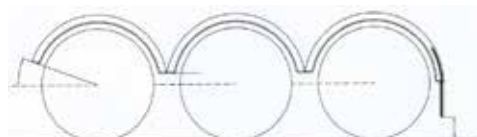
Beispiel 2. Nicht gelenkte Räder, Abstand zwischen den Reifenlaufflächen weniger als 250 mm.
